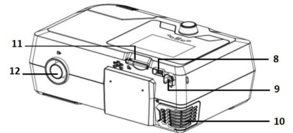
8. Puerto de comunicaciones. 9. Entrada alimentación DC. 10. Filtro de entrada de aire. 11. Ranura para tarjeta SD. 12. Salida de aire.
