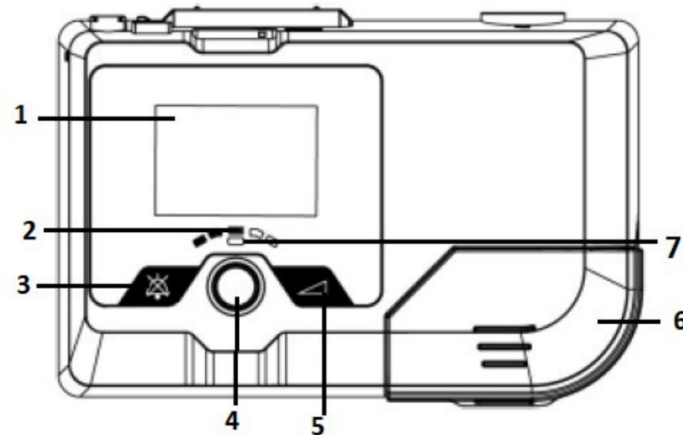
1. Pantalla. 2. Indicador del humidificador. 3. Botón para silenciar. 4. Perilla/botón de mando. 5. Botón de rampa. 6. Cámara de agua. 7. Indicador de encendido.
